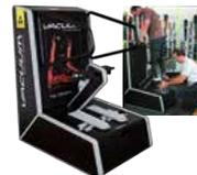
シェル全体のフィッティングが可能なバキュームステーション。ユーザーが可動式のプラットフォームに乗り、前傾角など任意のスキーポジションの設定を物理的に調整しながらフィッティングを実行する。シェル成型は、オープンで加熱したシェルにインナーを入れて履き、クーリングパッドを装着して圧縮することでフルフィットが完成する。
