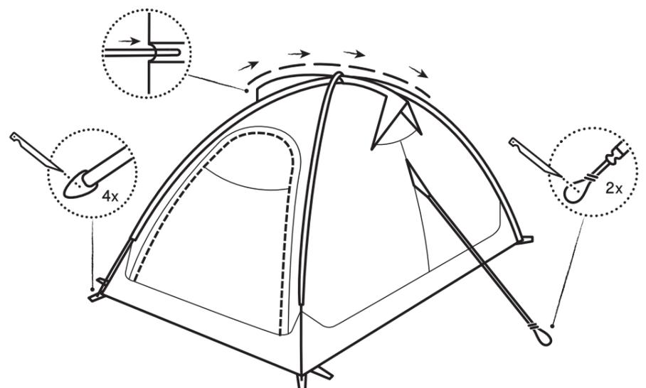
テント本体の中央にあるスリーブに短いポールを差し込み、アーチ状に固定します。テントの設営位置を決め、テントの四隅をサイドウォールの引き紐にペグを打ち、テントを固定します。
