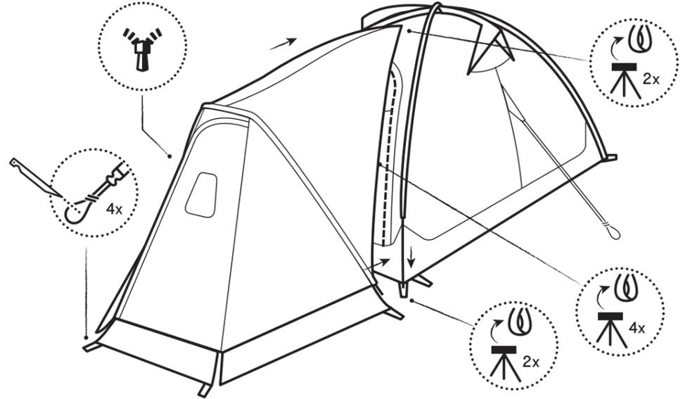
フライシートについているトグルを本体側のループに通し、本体とドッキングさせます。ジッパーを閉じた状態で前室のループにペグを打ち、地面へ固定します。最後に引き紐のテンションを調整し、全体のバランスを整えてください。
