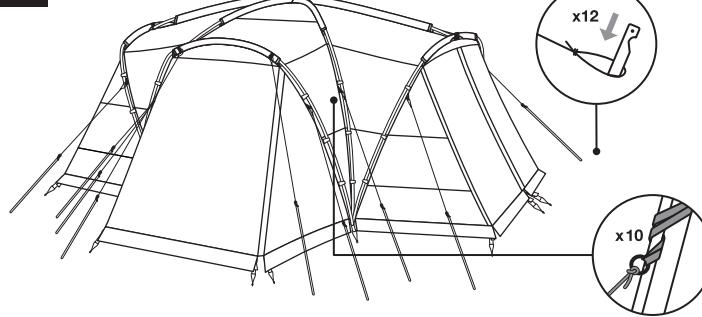
最後に外側のガイラインを張りペグで固定し、テンションを調整して全体のバランスを整えてください。ポール部のガイラインはポールにテープを巻きつけて張ってください。テープをポールに巻きつけてガイラインを張ることにより耐風性が向上します。
