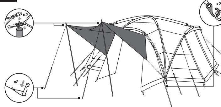
入口を必要に応じて跳ね上げることが可能ですが。跳ね上げた際に入口両サイドについているサイドウォールも使うことで雨風の浸入を軽減します。サイドウォールから伸びているフックを、3本のポールを差したテープのリングに引っかけて固定します。
